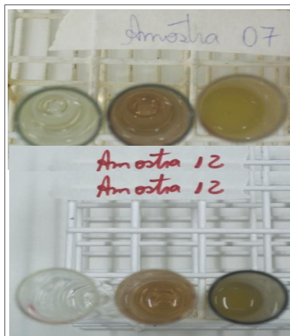
Figura 4: Amostra 7 e 12 apresentando maior turbidez em relação ao branco e ao controle, indicando visualmente alta presença de metais pesados.
